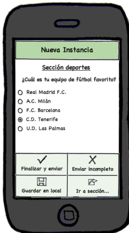
Figura 5-11 *Mockup* de un campo tipo *radio-button* con las opciones del menú.
