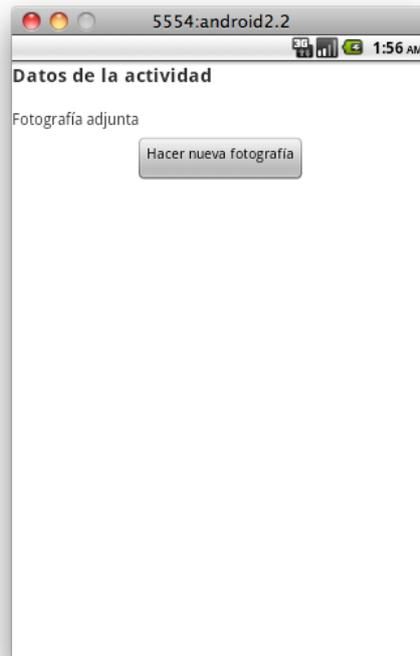
Figura 7-21 Ejemplo de campo imagen con un botón para lanzar la herramienta de fotografía.
